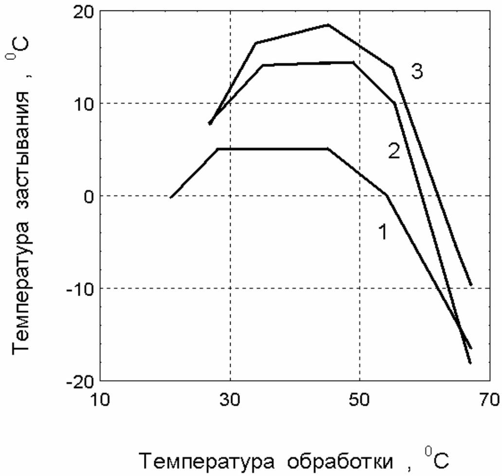
**Рис. 3.** Зависимости температуры застывания мазутов различной вязкости от температуры термической обработки (согласно [11]).
