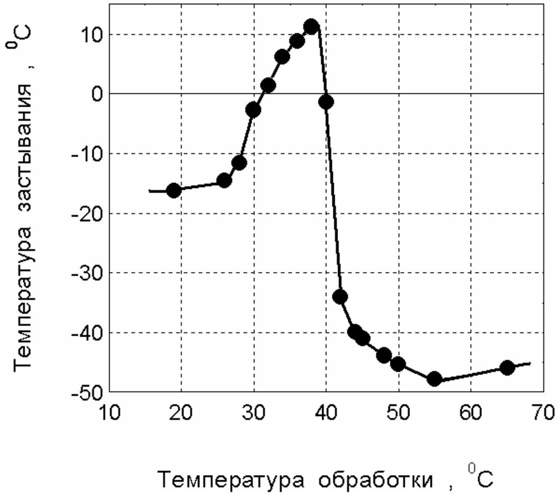
**Рис. 2.** Зависимости температуры застывания от температуры термообработки нефтей различных месторождений (согласно [3]).
