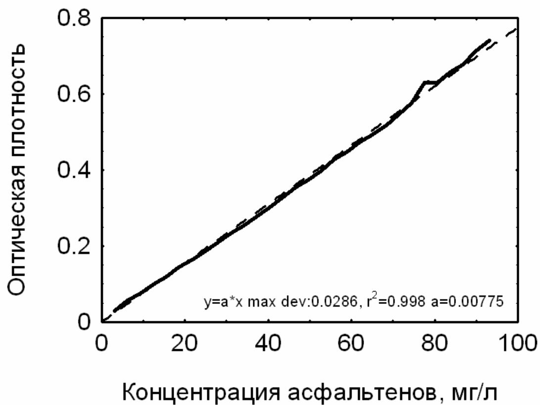
Рисунок 3. Зависимость оптической плотности растворов нефти в толуоле от концентрации асфальтенов.
