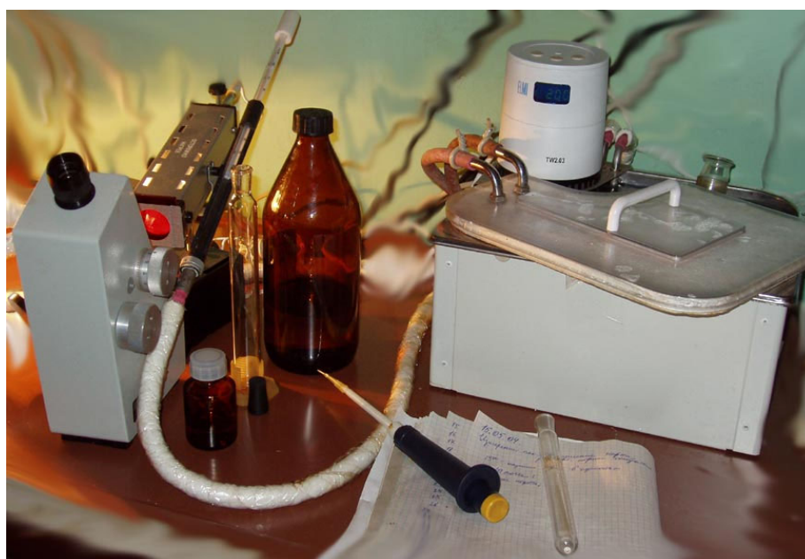
Рис. 4. Лабораторная установка для измерения показателя преломления
