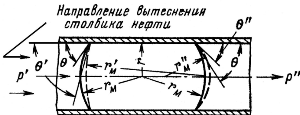
Рис. 1. Схема деформации капли в капилляре постоянного поперечного сечения.
